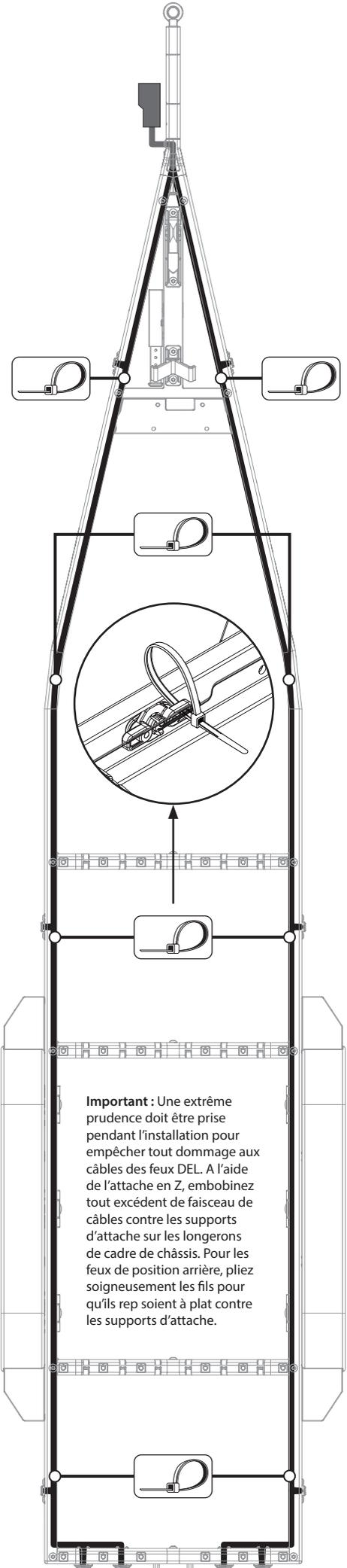
**Important :** Une extrême prudence doit être prise pendant l'installation pour empêcher tout dommage aux câbles des feux DEL. A l'aide de l'attache en Z, embobinez tout excédent de faisceau de câbles contre les supports d'attache sur les longerons de cadre de châssis. Pour les feux de position arrière, pliez soigneusement les fils pour qu'ils rep soient à plat contre les supports d'attache.
